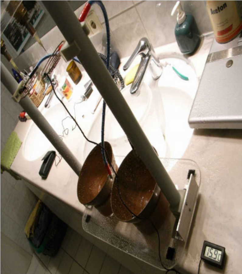
Temperaturmessung des abkühlenden Wasserraums des Kelvingenerators /
