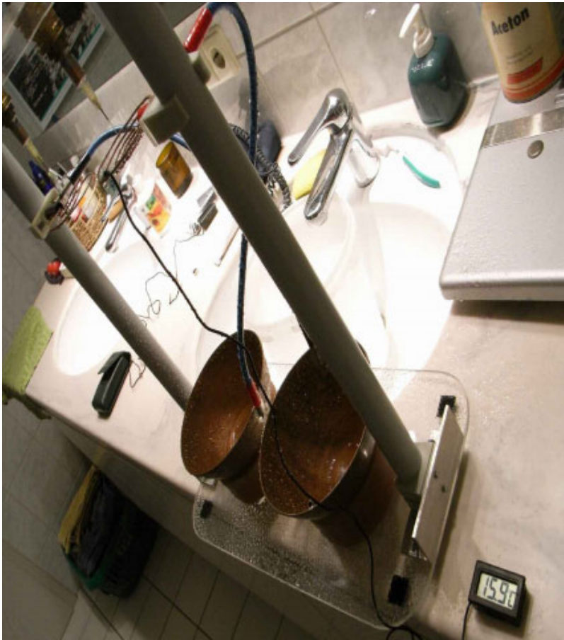
Temperaturmessung des abkühlenden Wasserraums des Kelvingenerators /
