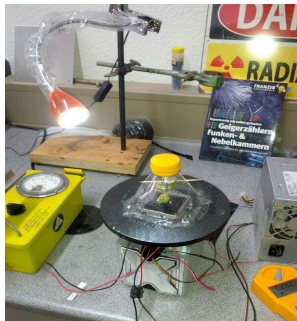
Nebelkammer mit CPU-Kühler und Peltiers
